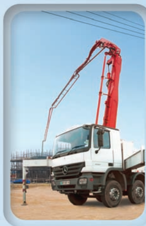
Pompe à béton
