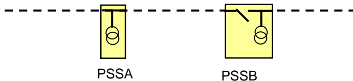
Figure 13 : Schéma correct (coupure entre les deux tangentes)
